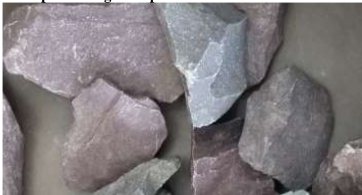
Figura 29- Aspecto dos grãos após os ciclos de umedecimento e secagem.
