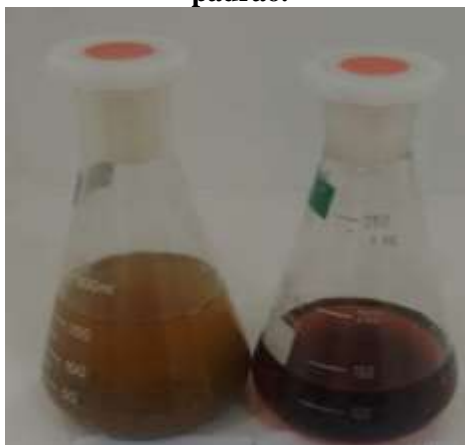
Figura 17- Erlenmeyers contendo amostra de areia imersa em hidróxido de sódio e solução padrão.
