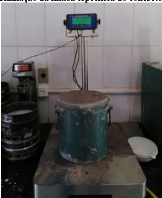
Figura 25 - Determinação da massa específica do concreto no estado fresco.
