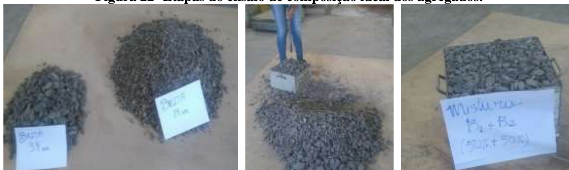
Figura 22- Etapas do ensaio de composição ideal dos agregados.
