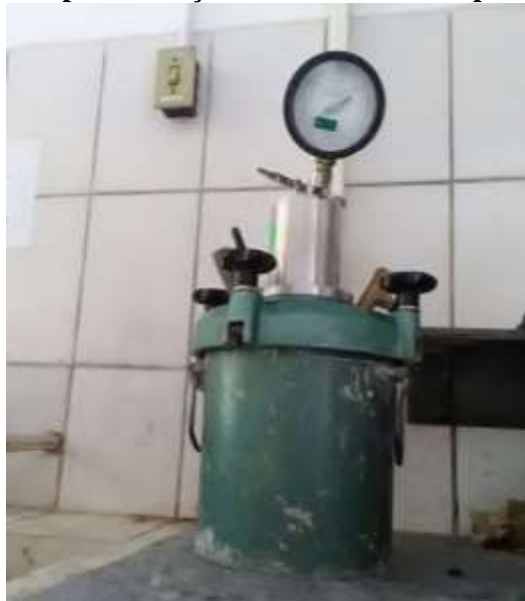
Figura 26- Sistema para medição do teor de ar incorporado no concreto.
