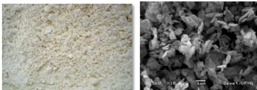
Figura 9 - Metacaulim- a) metacaulim de cor branca b) micrografia do material com aumento de 10.000x.
