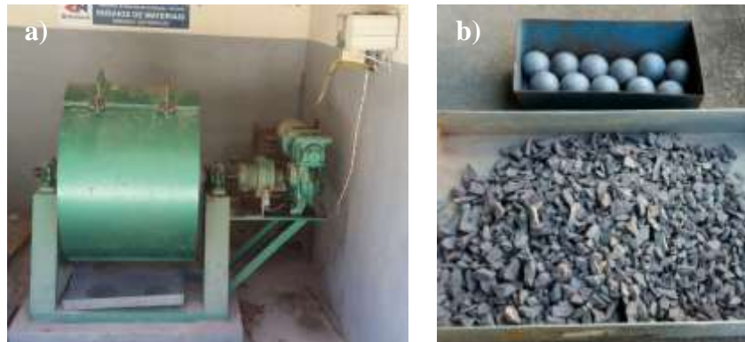
Figura 15 - Ensaio de abrasão a) equipamento Los Angeles e b) esferas metálica e amostra de brita.
