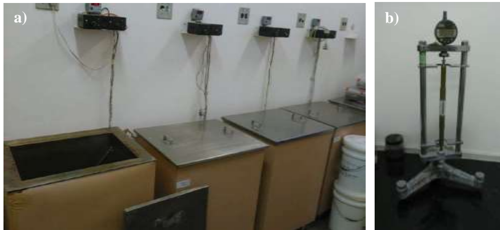
Figura 19- Ensaio de RAA a) Tanques de imersão com solução de hidróxido de sódio e b) Dispositivo de medição do comprimento das barras de argamassa.
