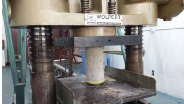
Figura 27 – Ensaio de resistência à compressão em prensa universal.
