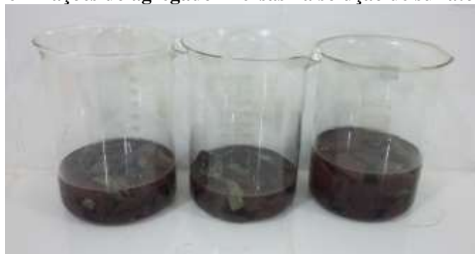
Figura 16- Frações do agregado imersas na solução de sulfato de sódio.
