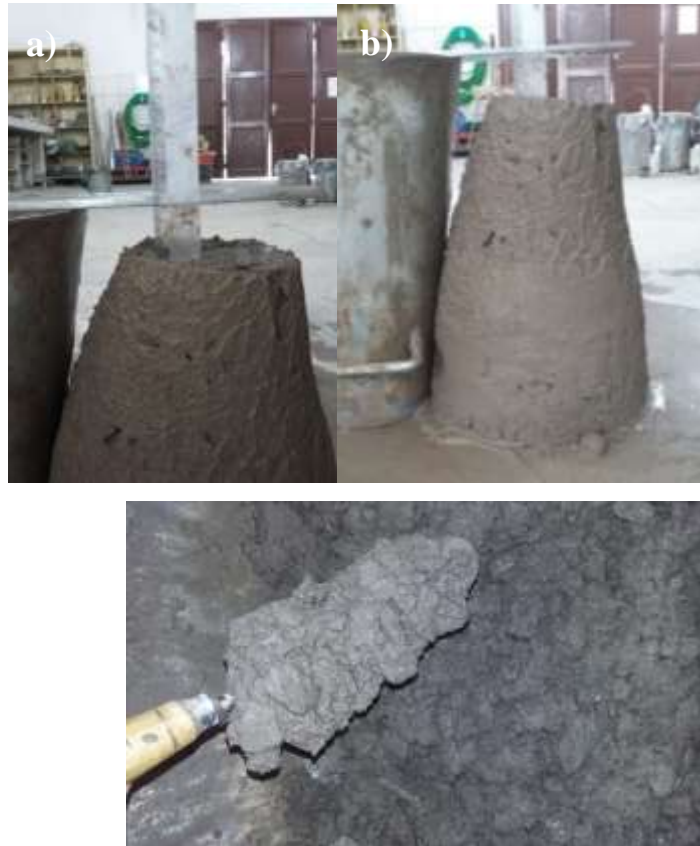
Figura 30 - Aspecto dos concretos produzidos no estudo de dosagem: a) medição do abatimento; b) ausência de exsudação; c) avaliação da coesão do concreto.
