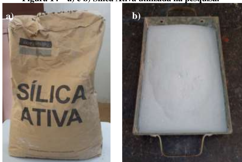
Figura 14 – a) e b) Sílica Ativa utilizada na pesquisa.
