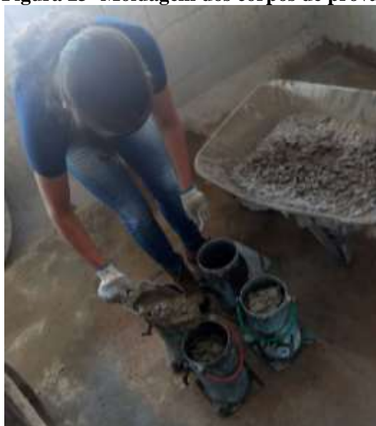
Figura 23- Moldagem dos corpos de prova.
