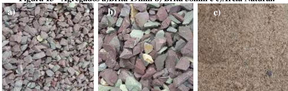
Figura 13 - Agregados a) Brita 19mm b) Brita 38mm e c) Areia Natural.
