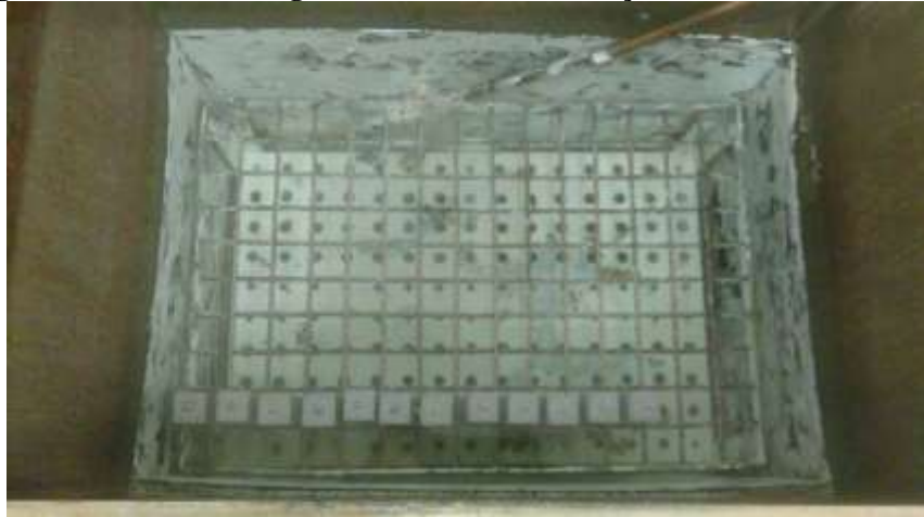
Figura 20- Barras de argamassa imersas na solução de hidróxido de sódio.
